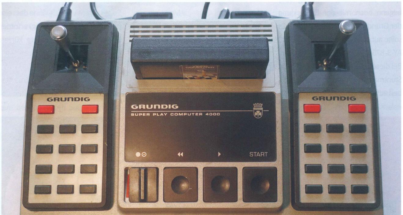
Abb.4: Grundig Super Play Computer SPC 4000 (Spielkonsole; Handspielgeräte mit Steuerknüppeln und Tastenfeld).
